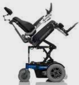
RS-6000036 / 6000243 Elevazione elettrica seduta (30 cm) + basculamento elettrico 45°/52°
