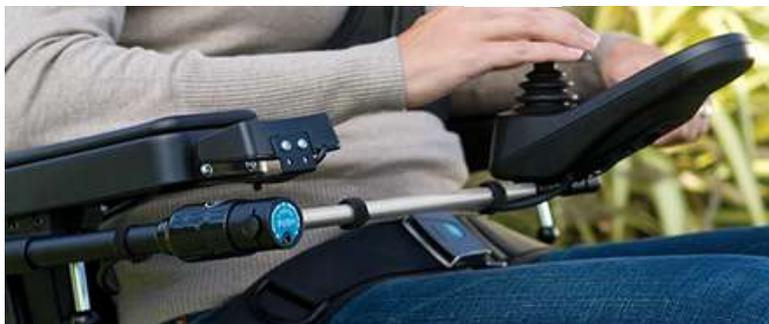
Montare la staffa rotante Tri-Lock in orizzontale per posizionare un joystick controllato dalla mano davanti al corpo, sulla linea mediana, o in qualsiasi punto del braccetto per soddisfare le esigenze individuali.
