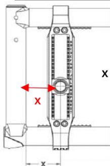
Misurare la distanza dalla parte anteriore del tubo schienale ed il centro del mozzo.
