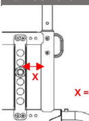
Misurare la distanza dalla parte anteriore del tubo schienale ed il centro del mozzo.
