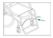
Misura distanza tubo-tubo delle pedane passando dietro i polpacci dell'occupante.
